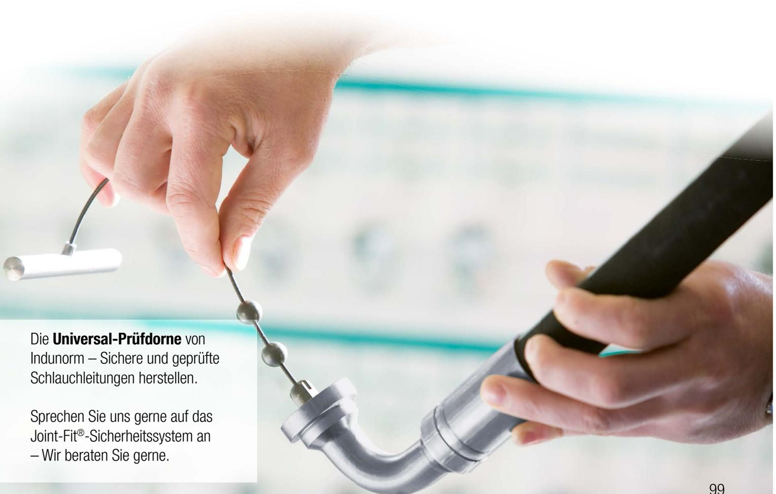
Die **Universal-Prüfdorne** von Indunorm – Sichere und geprüfte Schlauchleitungen herstellen.
